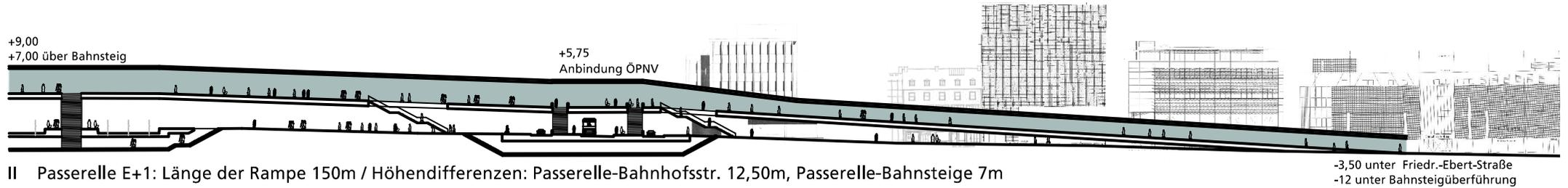
II Passerelle E+1: Länge der Rampe 150m / Höhendifferenzen: Passerelle-Bahnhofstr. 12,50m, Passerelle-Bahnsteige 7m
