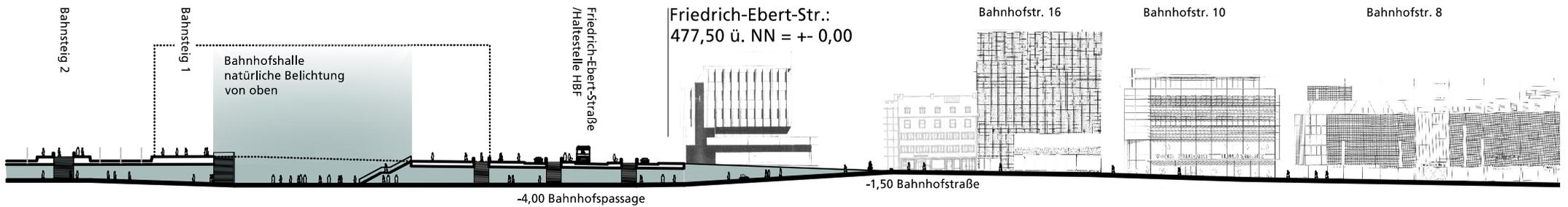
I Passage E-1: Länge der Rampe 45m / Höhendifferenzen: Halle-Bahnsteig 5,50m, Halle-Bahnhofstr. 2,50m
