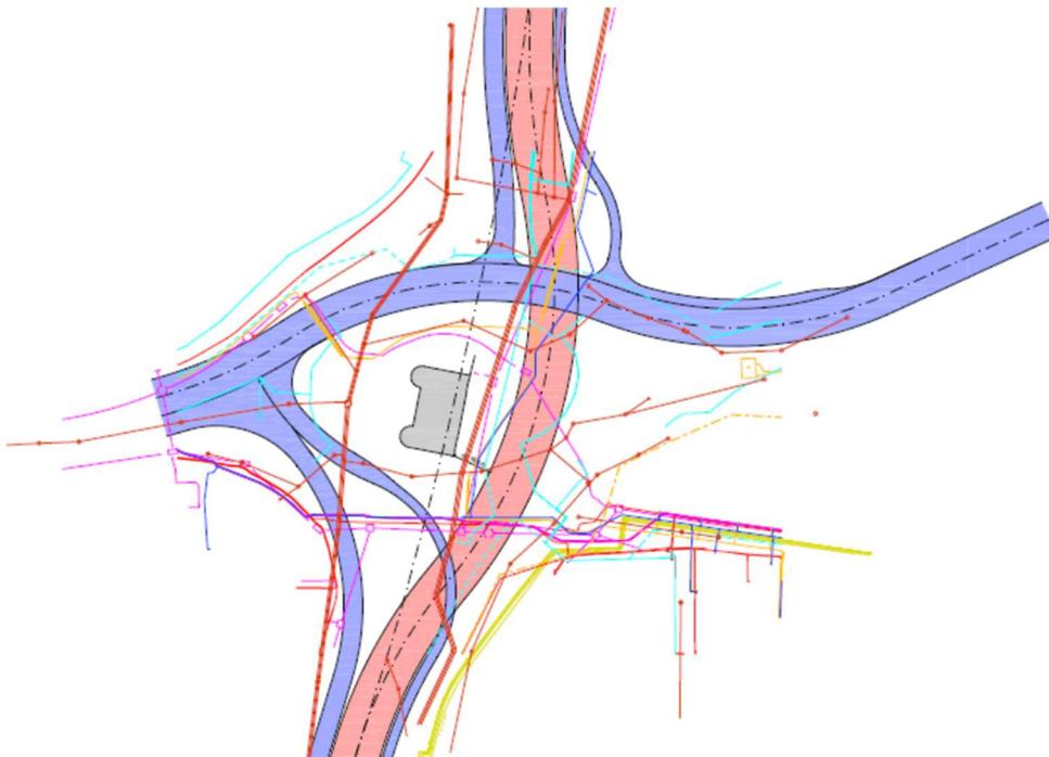
Abb. Ver- und Entsorgungsleitungen im Bereich der geplanten Maßnahme
