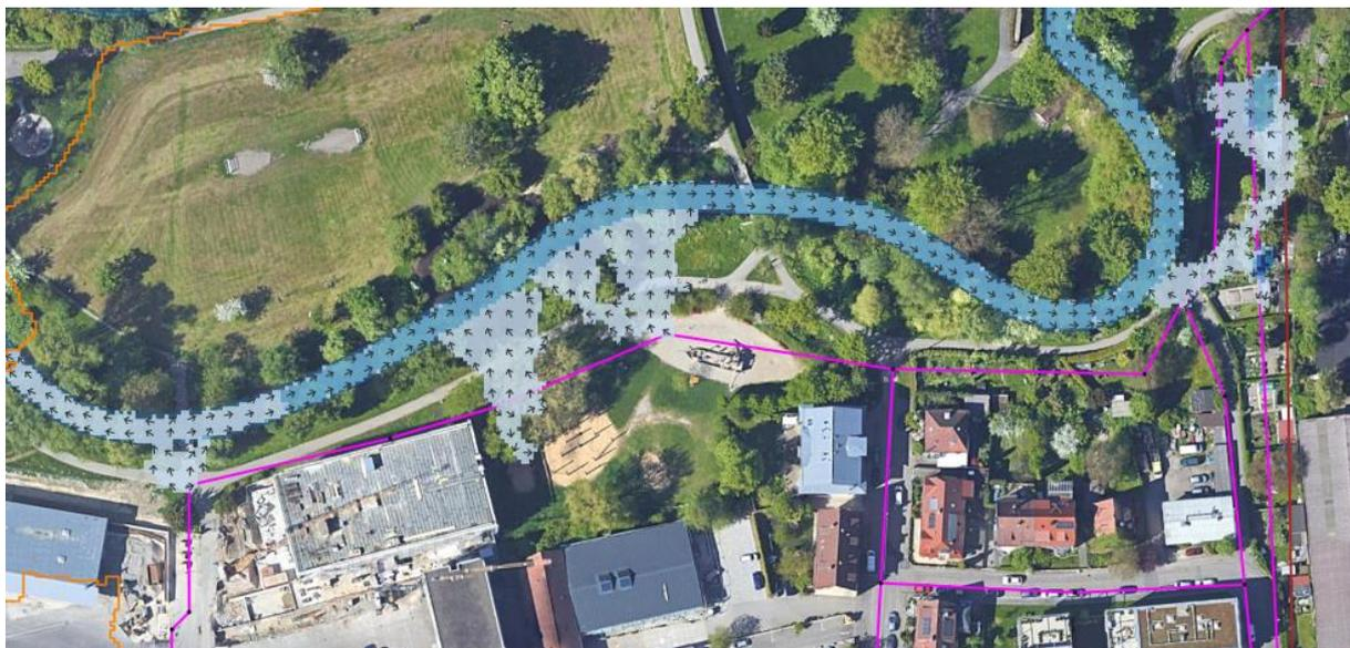
Abbildung 4: Ausschnitt aus der Ergebniskarte der gekoppelten 2D-Simulation; dargestellt sind Fließtiefen und -richtung der kanalindizierten Überflutung ohne Wasserrückführung für den Modellregen Euler-II-D120-T5
