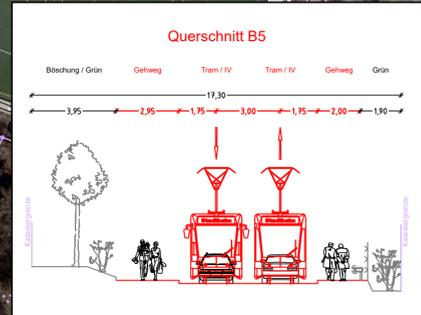
ab hier Trasse auf unabhängigem Bahnkörper
