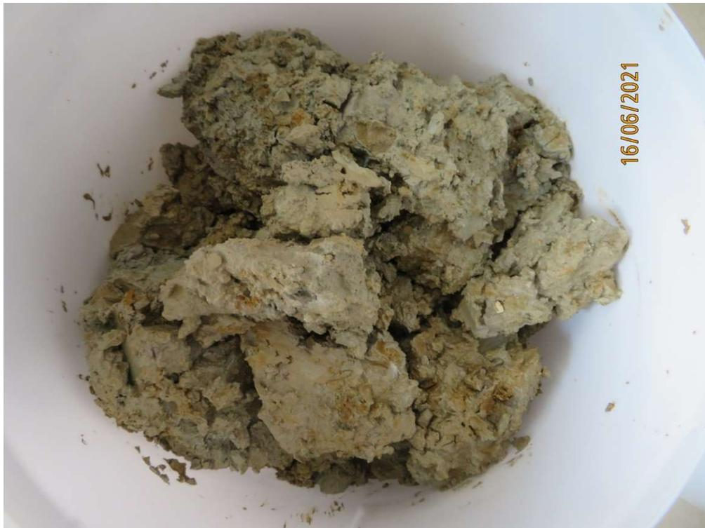
**Abb. 6:** Baggerschurf 2 Probe für Bodenmechanische Untersuchungen 2,7 – 3,0m
