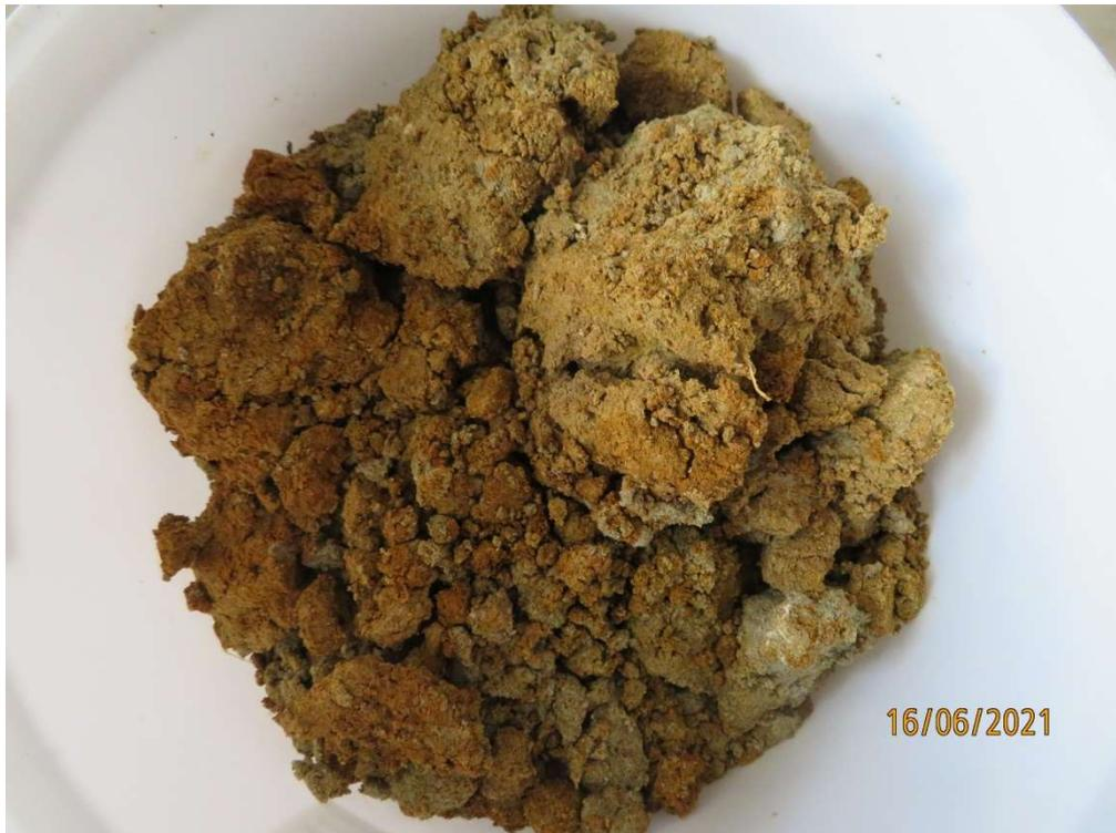
**Abb. 6:** Baggerschurf 5 Probe für Bodenmechanische Untersuchung 3,0 – 3,3m
