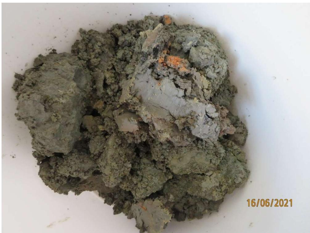
**Abb. 7:** Baggerschurf 1 Probe für Bodenmechanische Untersuchung 2,6 – 3,1m
