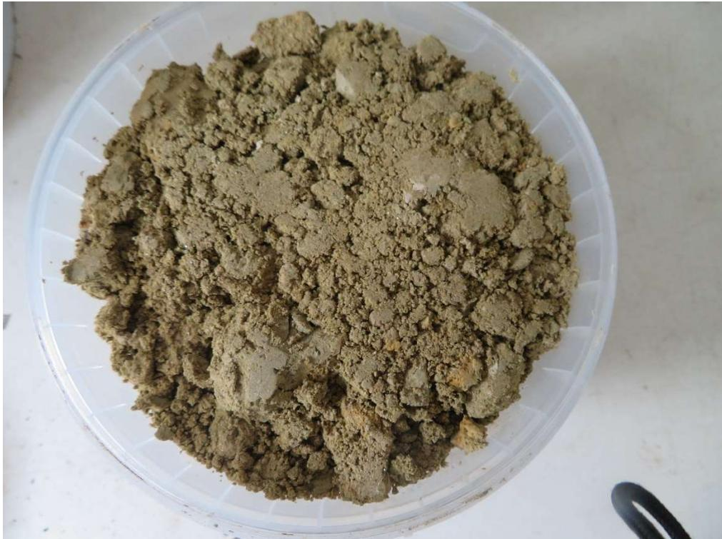
**Abb. 7:** Baggerschurf 6 Probe für Bodenmechanische Untersuchung
