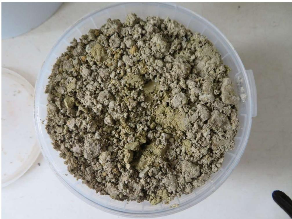
**Abb. 8:** Baggerschurf 4 Probe für bodenmechanische Untersuchungen
