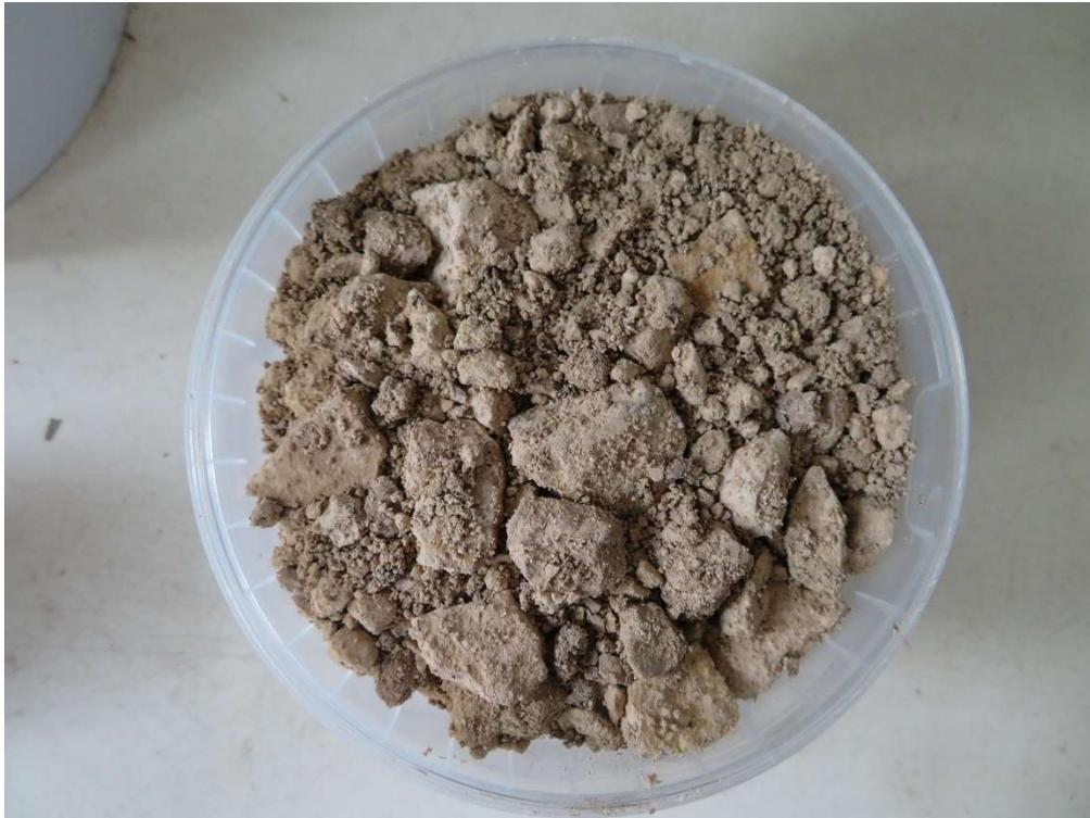
**Abb. 7:** Baggerschurf 3 Probe für bodenmechanische Untersuchungen
