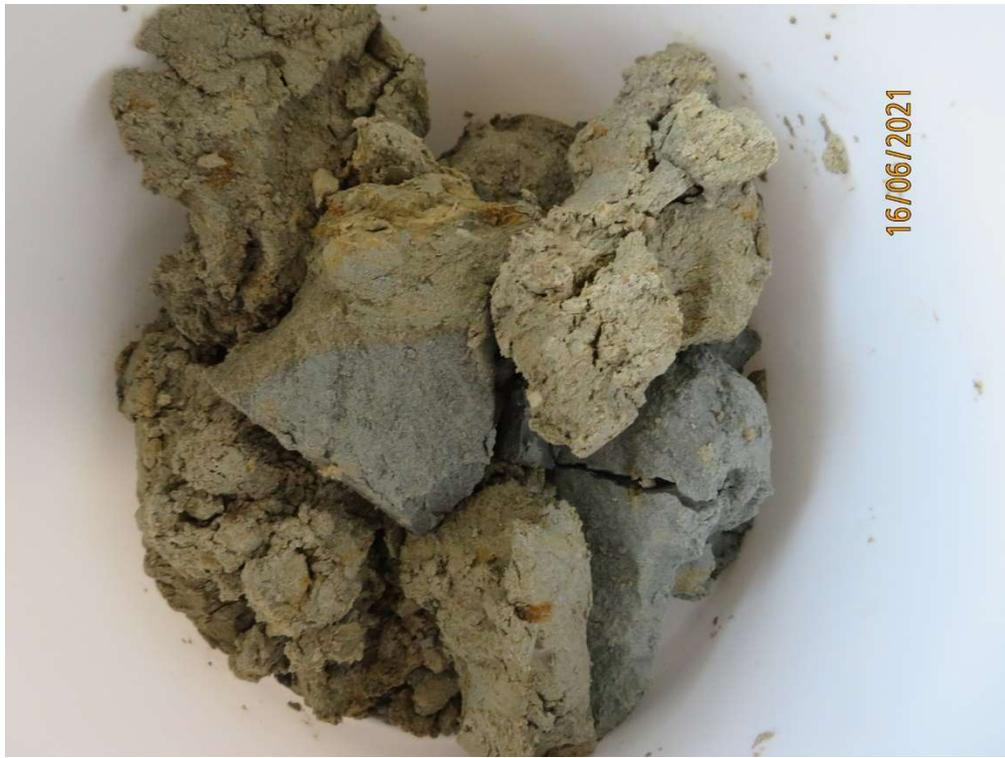
**Abb. 6:** Baggerschurf 1 Probe für Bodenmechanische Untersuchungen 2,3 – 2,6m
