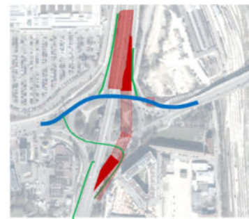
Bauphase 4 Verkehr zum Teil über Behelfsrampen
