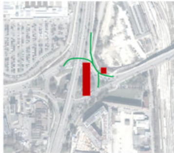
Bauphase 2 Verkehr über Behelfsumfahrung
