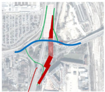
Bauphase 3 Verkehr über neue Ost-Westachse
