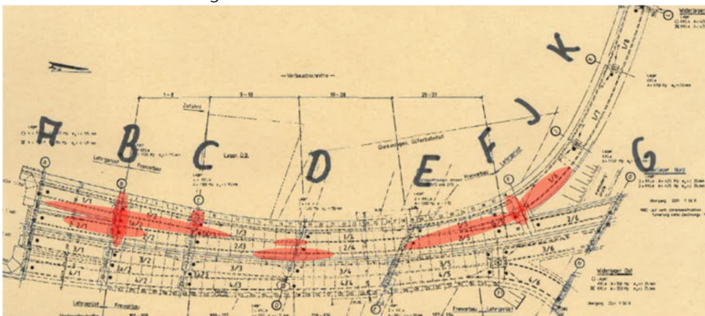
Abb. Stellen mit Schadenshäufungen am westlichen Überbau
