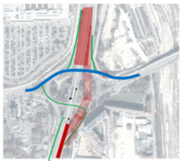
Bauphase 5 Verkehr zum Teil über Behelfsrampen
