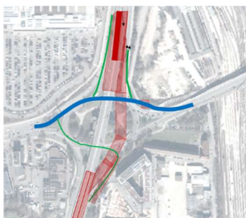
Bauphase 7 Verkehr durch Tunnel
