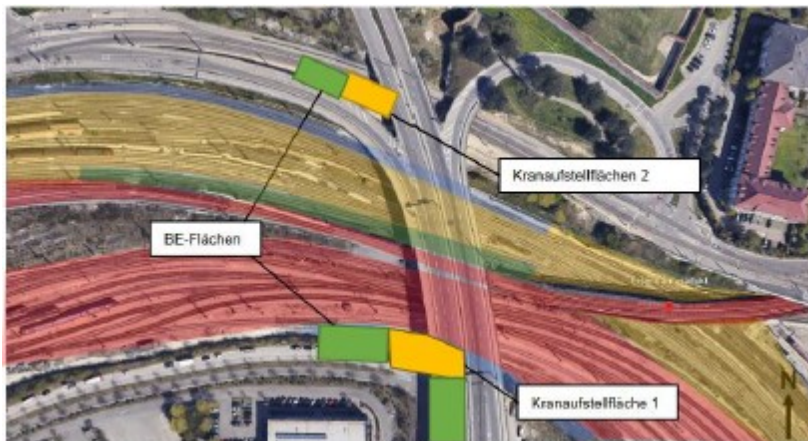
Abb. Konzept Rückbau West
