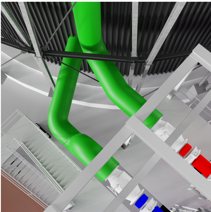
Wunschlage der Zuleitung - Höhe der Einführungspunkte Leitungen in den Speicher unverändert
