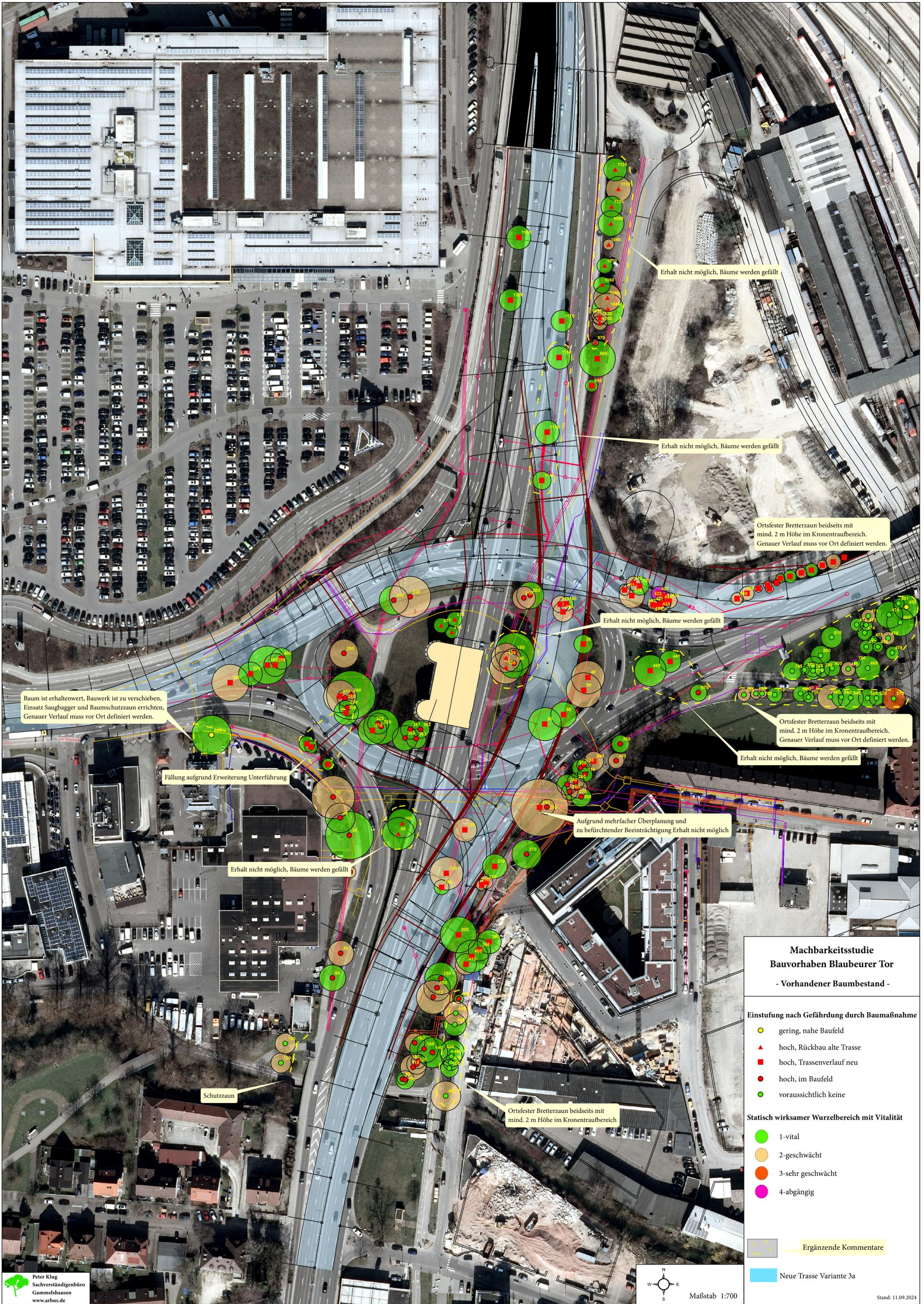
Baum ist erhaltenwert, Bauwerk ist zu verschieben, Einsatz Saugbagger und Baumschutzzaun errichten, Genaue Verlauf muss vor Ort definiert werden.
