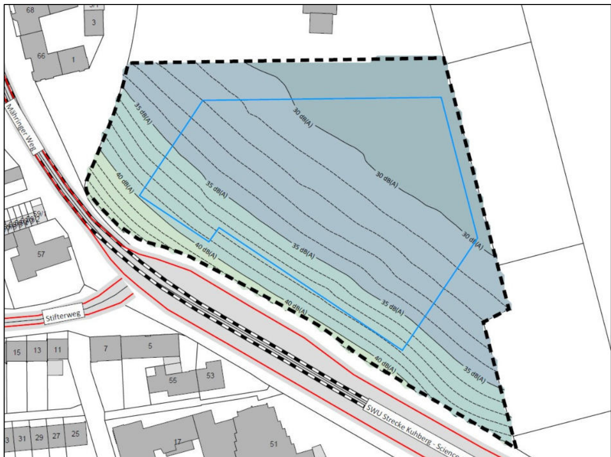
Abbildung 6: Erforderliche Schalldämm-Maße der Außenbauteile nach DIN 4109:2018 in dB (Karte 5 der Anlagen der schalltechnischen Untersuchung)
