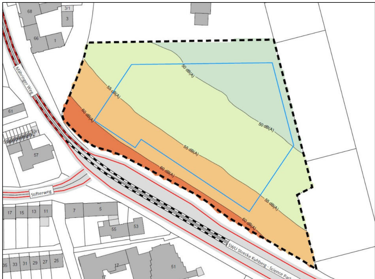
Abbildung 7: Beurteilungspegel Nacht nach der DIN 18005 (Karte 2 der Anlagen der schalltechnischen Untersuchung)
