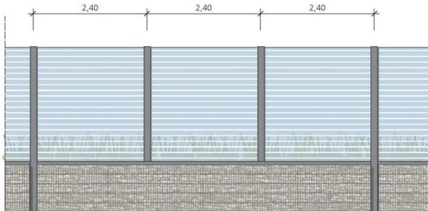
**Ansicht Lärmschutzwand auf Betongleitwand:**
