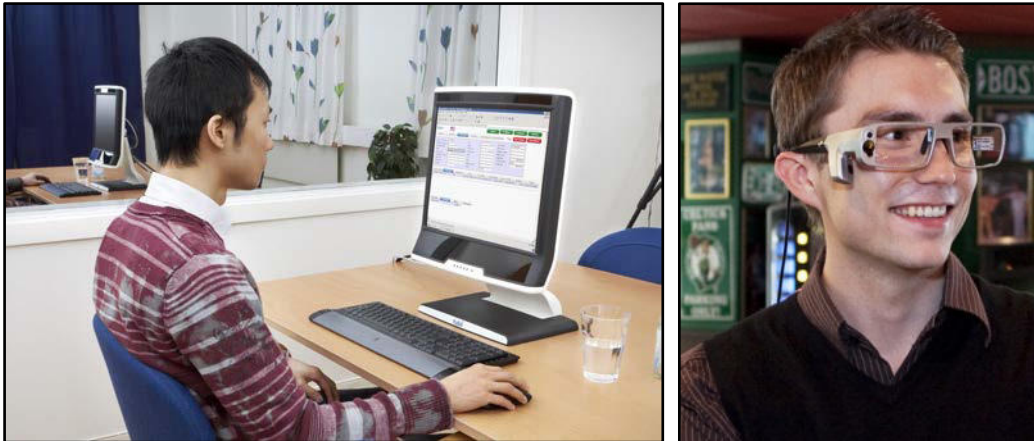
Abb. 2: Stationäres Eye-Tracking-System (links) und mobiles Eye-Tracking-System ( glasses ) Quelle: www.tobii.com mit freundlicher Genehmigung
