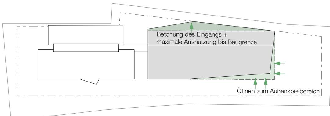
Im Nordwesten knickt die Fassade unter dem Dach nach innen wodurch ein Vorplatz mit überdachtem Eingangsbereich entsteht. Zudem werden die Besucher durch den Knick ganz selbstverständlich zum Eingang geführt.
