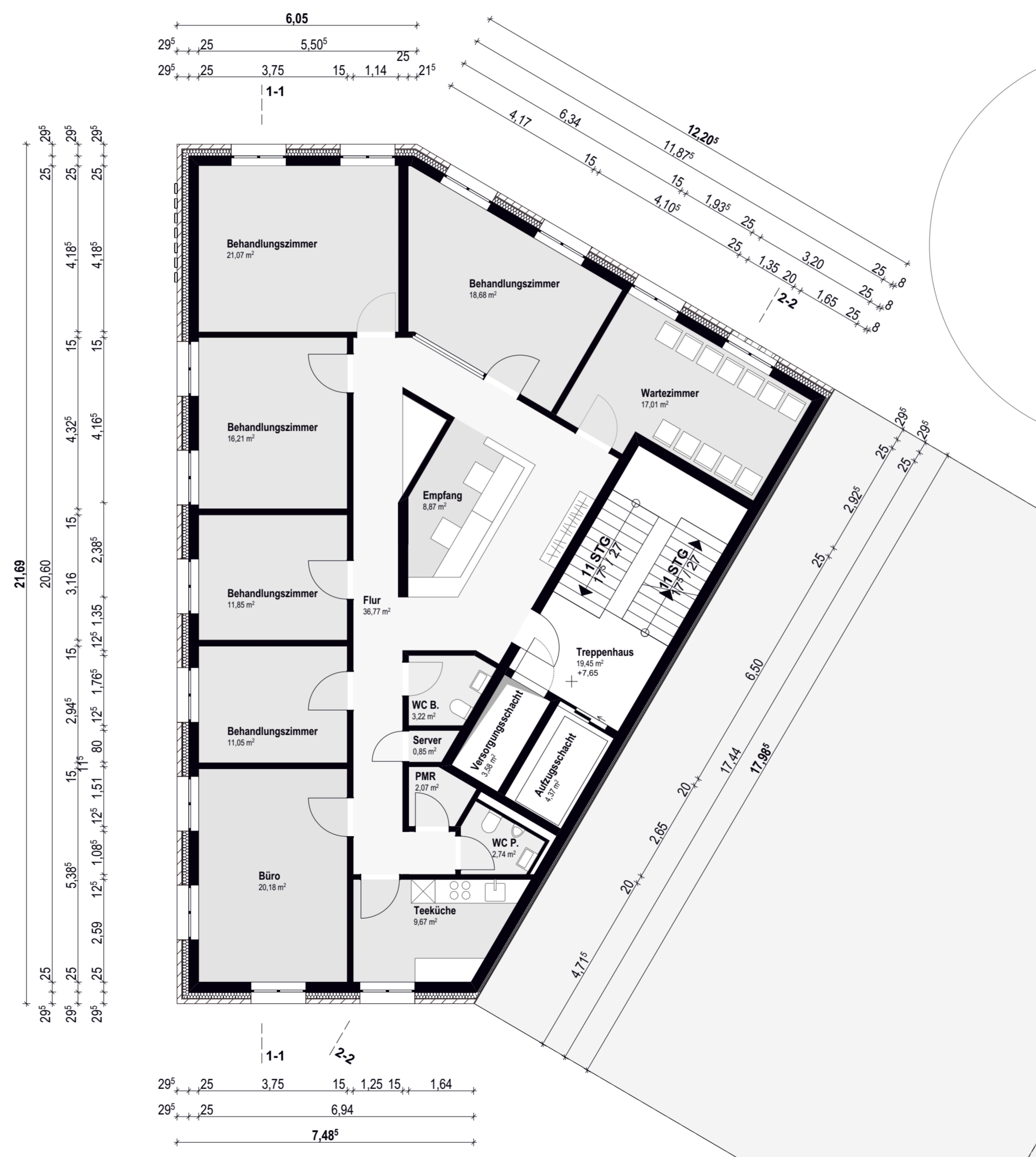
SB 1.1 04 Grundriss 2. Obergeschoss
