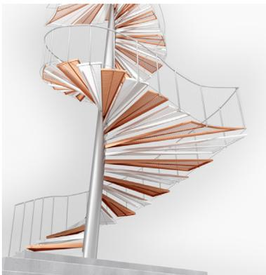
**Statik:** Spindelrohr 400,6 x 12,5mm (Wandstärke) Stahlgüte S355, Verformung Rohr: Eigenlastverformung = 6 cm zur Donauseite unter Volllast (80 Menschen à 100 kg), im Abstand von 1m vom Rohr (Stufenmitte), Rohrverformung in 16 m Höhe = ca. 12 cm
