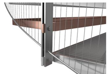
**Treppenkonstruktion:** übergreifende Verbindung der Treppenstufen und Stabilisierung durch tief liegendes Rohr erhöhte Sicherheit u. Festigkeit der Wendeltreppe und verringerte Schwingung.
