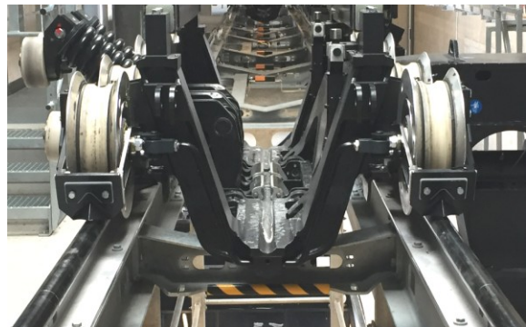
Abbildung 3: Ausstattungskomponenten Seilbahnkabine und Rollensystem auf Tragseilen
