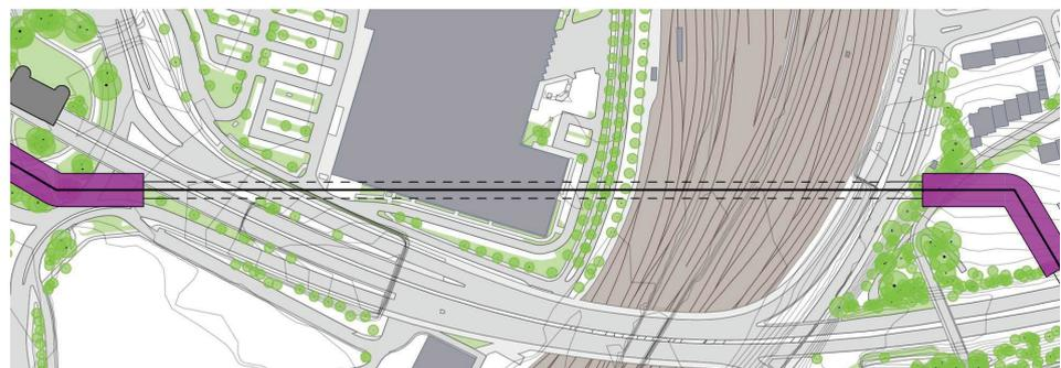
Abb. 32. Trassenkollisionen: Beispiel Bahnanlagen in Ulm
