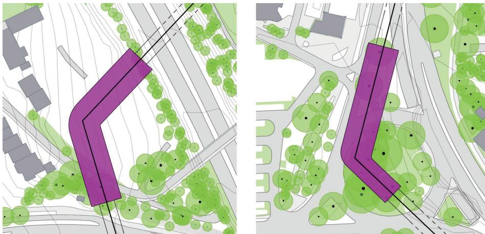
Abb. 6. Positionierung von Stationen (links, außerhalb von Straßenräumen: Ulm - Station Lehrer Tal/ rechts, in Straßenräumen: Um - Station Söflinger Kreisel)
