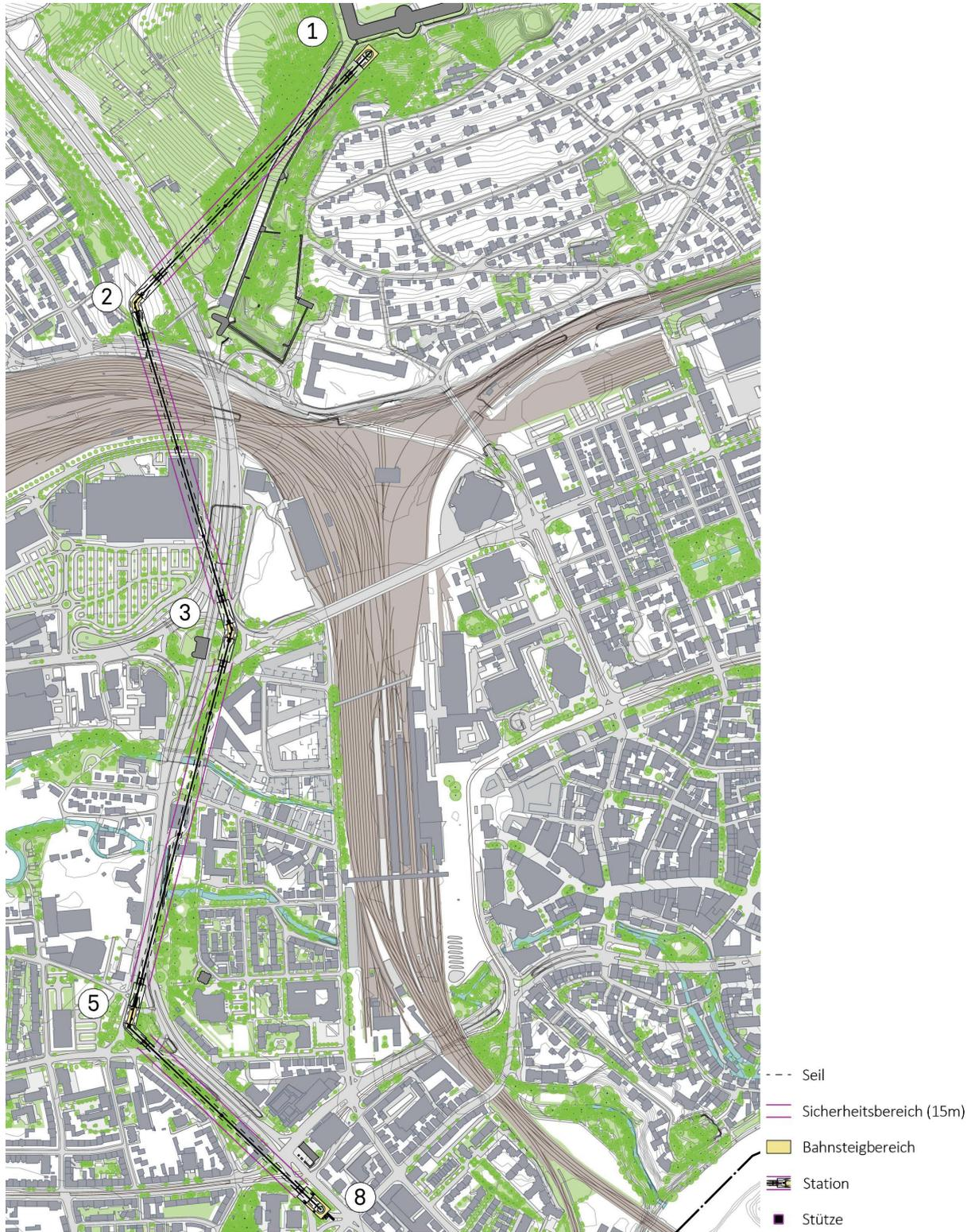
Abb. 60. Teilstrecke 1 in Ulm: Trasse A – Lageplan
