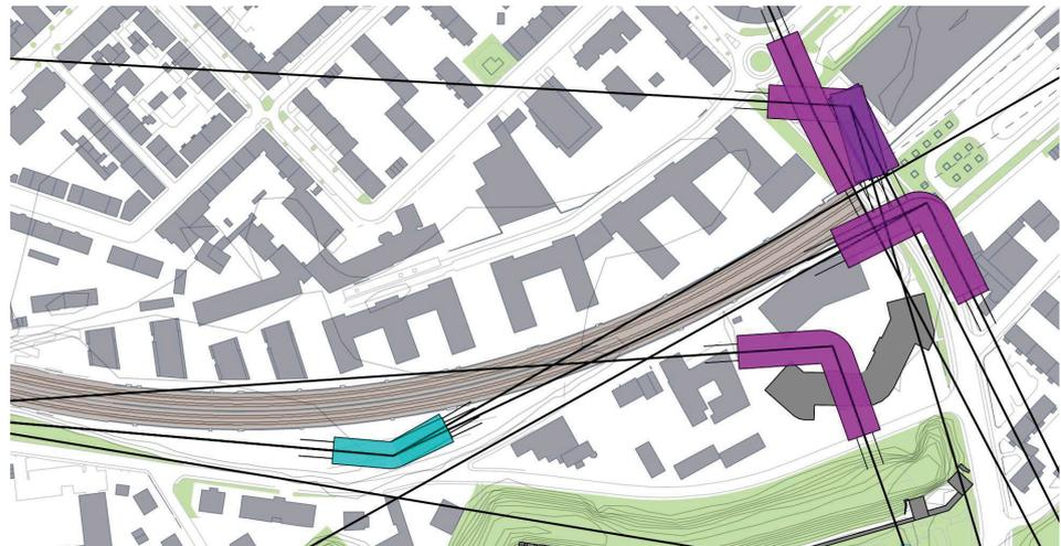
Abb. 31. Trassenkollisionen: Beispiel Bahnanlagen in Neu-Ulm
