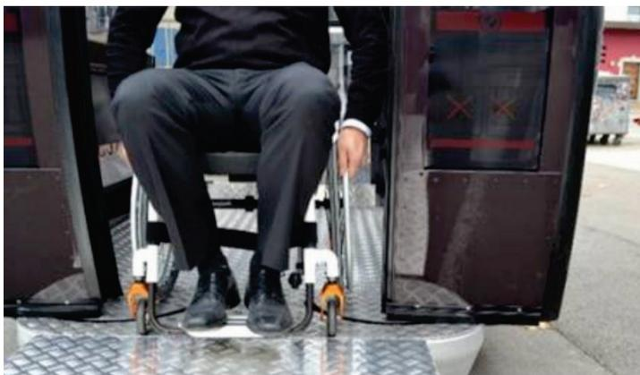
Abb. 5. Konflikt zwischen Rollstuhlfahrer und Kabine einer 1S-Seilbahn
