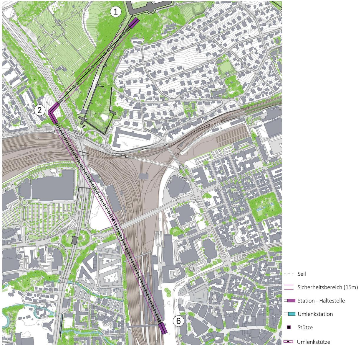
Abb. 64. Teilstrecke 1 in Ulm: Trasse C – Lageplan
