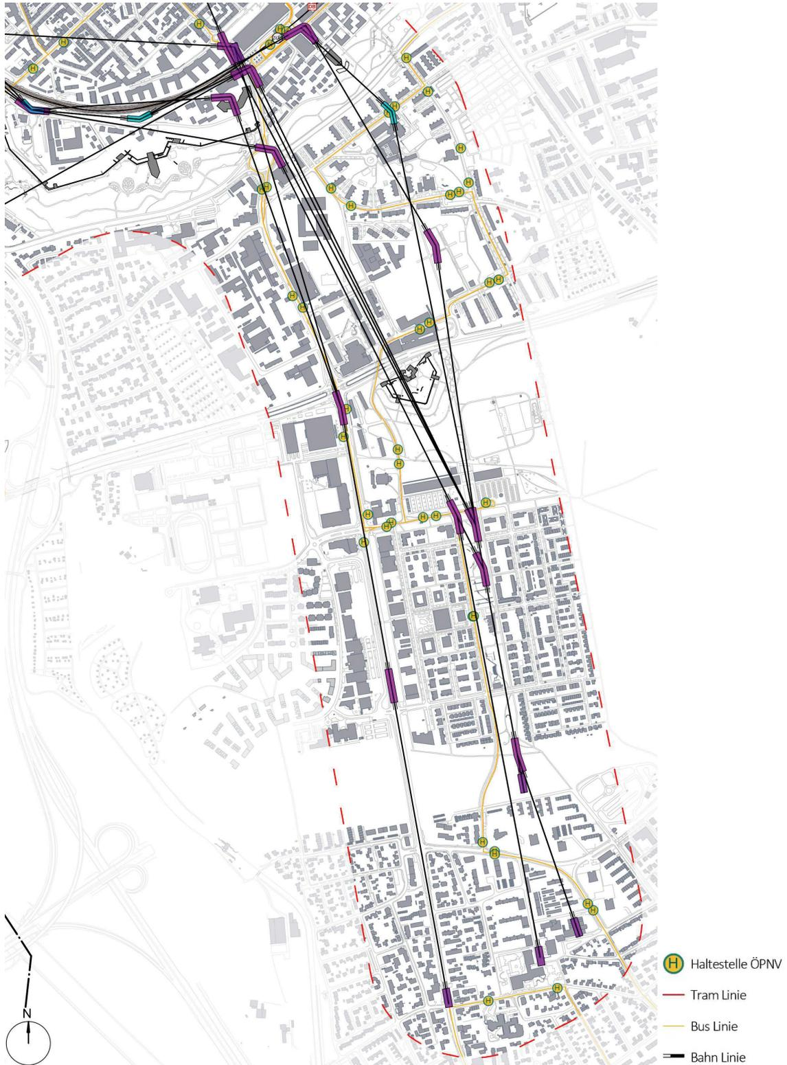
Abb. 56. Trassenbündel für Teilstrecke 3 – ÖPNV
