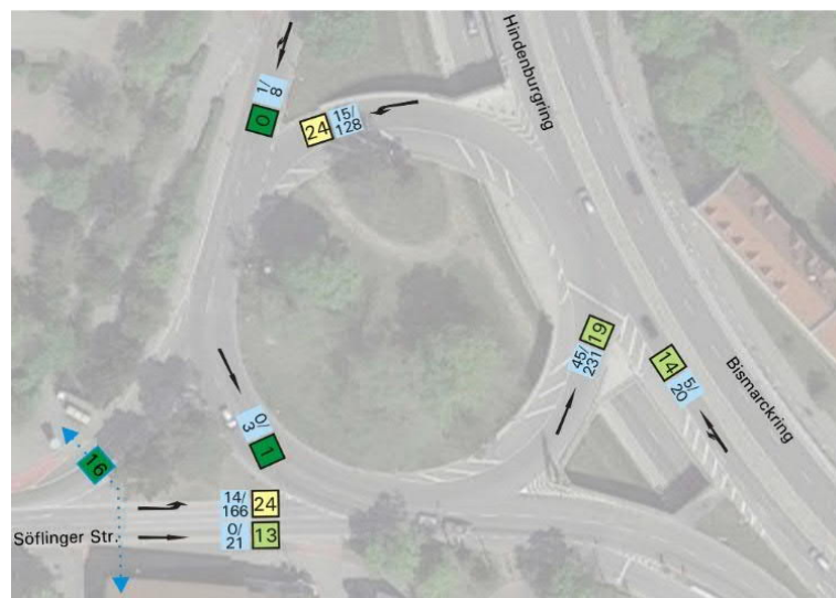
Abb. 38 Verkehrsqualitäten, Wartezeiten und Rückstaulängen am Söflinger Kreisel (bestandsoptimierte Variante), Spitzenstunde morgens (Legende s. Tab. 1)
