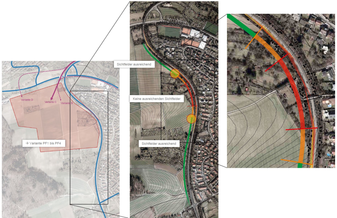
Abbildung 39 : Prüfung Sichtfelder Anbindung Kurt-Schumacher-Ring (PF1-4)
